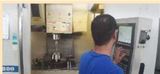
Figura 5. Usinagem em CNC do bloco de conexão do SMT-20
