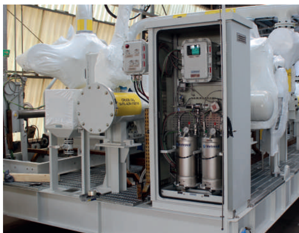
Reservatórios de amostras com balanças montados em gabinete de GRP (Poliéster Reforçado com Fibra de Vidro) ou aço inox com sistema de aquecimento para preservar a temperatura, a fim de evitar o congelamento das amostras.
